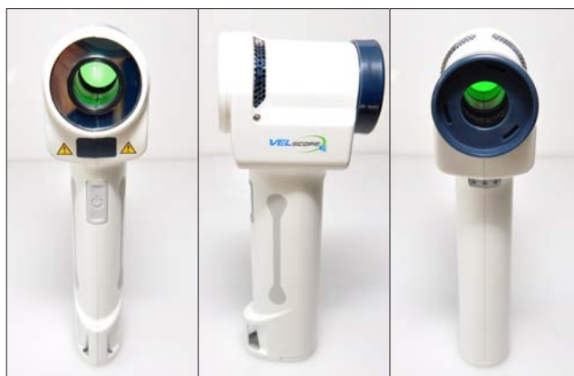
Rycina 1. Urządzenie VELscope VX służące do badania autofluorescencji błon śluzowych jamy ustnej
